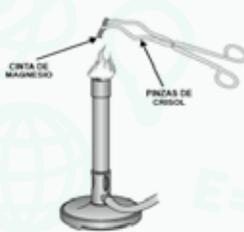
**1.** Tome una tira de magnesio (Mg) y sujétela con las pinzas, como se observa en la figura. Observe las características iniciales, como color, flexibilidad, etc. Coloque la tira en la llama del mechero y observe lo que acontece.
