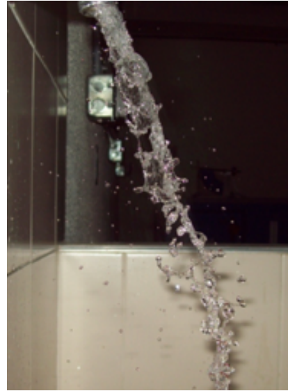
Figura 88. Flujo turbulento formado por un chorro de agua.
