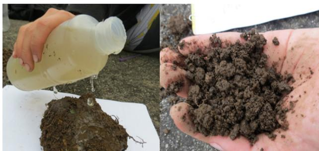
**Figura 3.** Determinación de la resistencia al rompimiento por horizonte.
