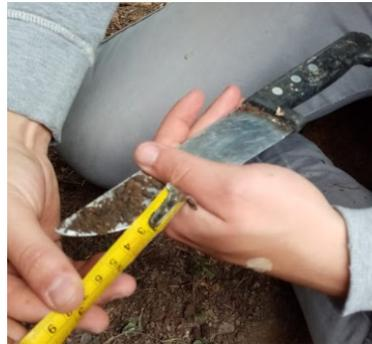
**Figura 7.** Medición de hasta dónde se introduce el cuchillo.
