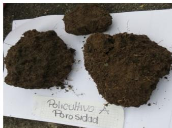
**Figura 2.** Punto A de un policultivo con cara expuesta para medir la porosidad del suelo.
