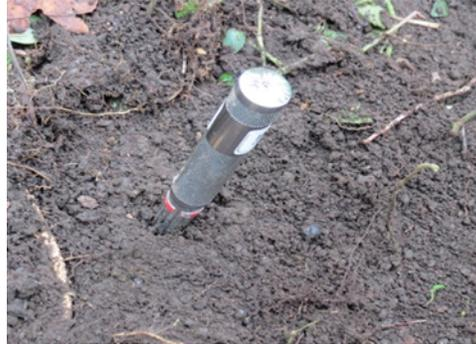
**Figura 9.** Resistencia a la penetración con un penetrómetro Concrete Pocket.
