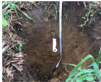
**Figura 5.** Cuchillo introducido en la cajuela a diferente profundidad.
