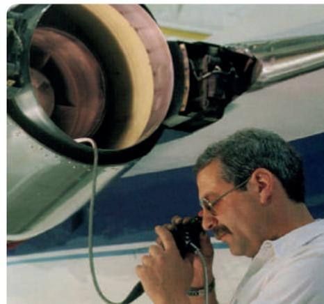
Figura 61. Inspección visual en turbinas de aviación (<http://bit.ly/2LT8pkQ>).
