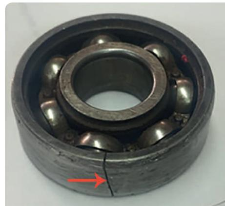
Figura 11. Falla en rodamiento por montaje incorrecto. Fuente: elaboración propia.
