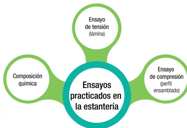
Figura 75. Ensayos realizados a la estantería. Fuente: elaboración propia.
