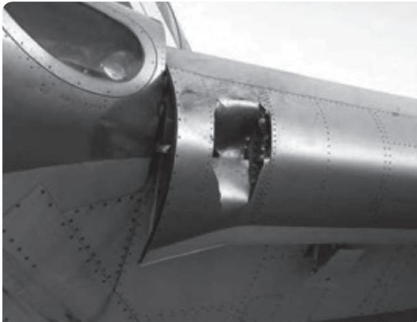
Figura 8. Fractura en la chapa del ala de un jet de pasajeros (Arana y González, 2003).
