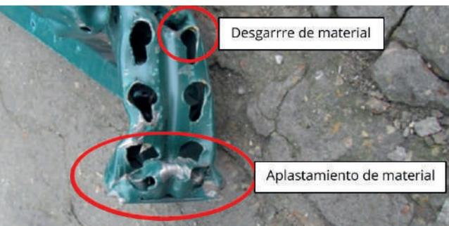
Figura 57. Columna línea 39, inicio del colapso. Fuente: elaboración propia.
