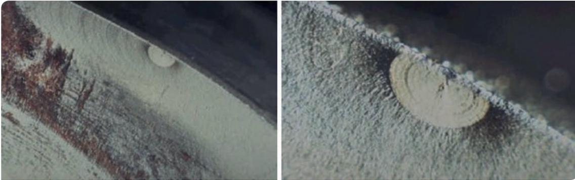
Figura 9. Inclusión subsuperficial en cigüeñal (<https://bit.ly/2MmK7ov>).
