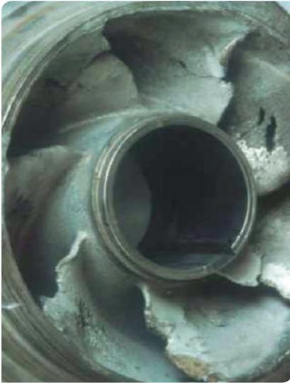
Figura 33. Desgaste por cavitación en bombas (Avellan, 2002).
