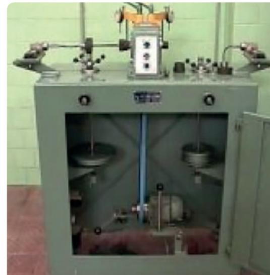
Figura 73. Máquina de ensayos de fatiga en viga rotativa (<https://bit.ly/2Lh3t98>).
