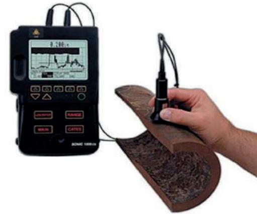
Figura 66. Equipo de ultrasonido usado para la medición de espesores en tuberías de petroleras (<https://bit.ly/2xjWp9O>).
