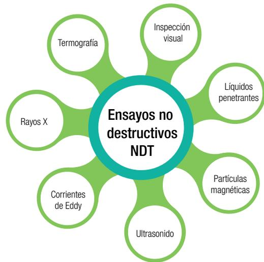
Figura 60. Clasificación de ensayos no destructivos usados en la detección de fallas. Fuente: elaboración propia.
