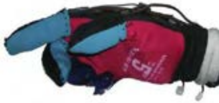
Figura 3. Guante de datos de 5 dedos con acelerómetros.
