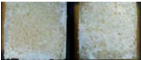
Figura 9. Superficies de falla de la probeta #8 junta de Tope (Q222).
