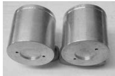
Figura 6. Transductores construidos a partir de PVDF-TrFE.
