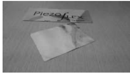
Figura 1. Material activo PVDF-TrFE con metalización en aluminio.
