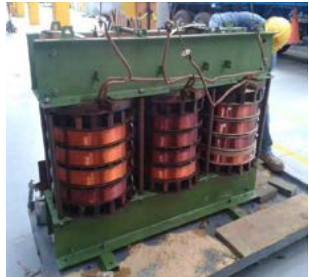
Figure 1 transformador de 1500kVA desensamblado.
