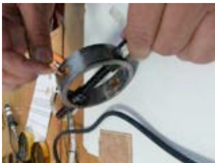
Figura 4. Aplicación de la protección de las galgas extensiométricas
