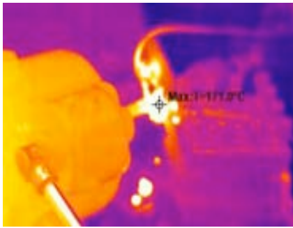
Figura 4. Toma de temperaturas de la probeta con cámara termográfica TP8S, durante el experimento
