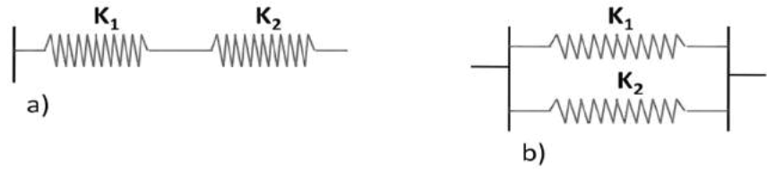
Figura 20. Resorte en serie (a) y paralelo (b)
