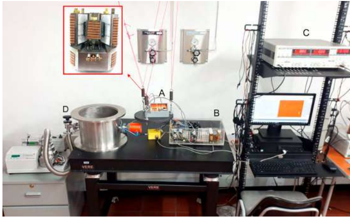
Figura 20. Sistema de microscopía de túnel de la Universidad Central Nota. (A) Cabezal del STM con sistema de amortiguamiento pasivo, electrónica de control de fabricación nacional (B), amplificador Lock-In (C) y sistema de alto vacío (D) con estación turbomolecular. Fuente: elaboración propia.
